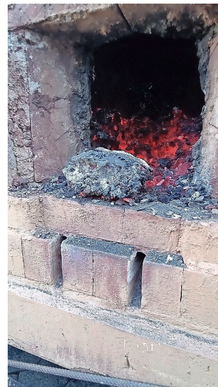
Erich Schwaninger kontrolliert die Hitze im Rennofen mit einem Spiegel. Bilder rechts: Bohnerz aus dem Hemming hat einen Eisengehalt von 35 bis 50 Prozent (oben). Ofen mit Luppe nach dem Öffnen (Eisen und Schlackengemisch).
