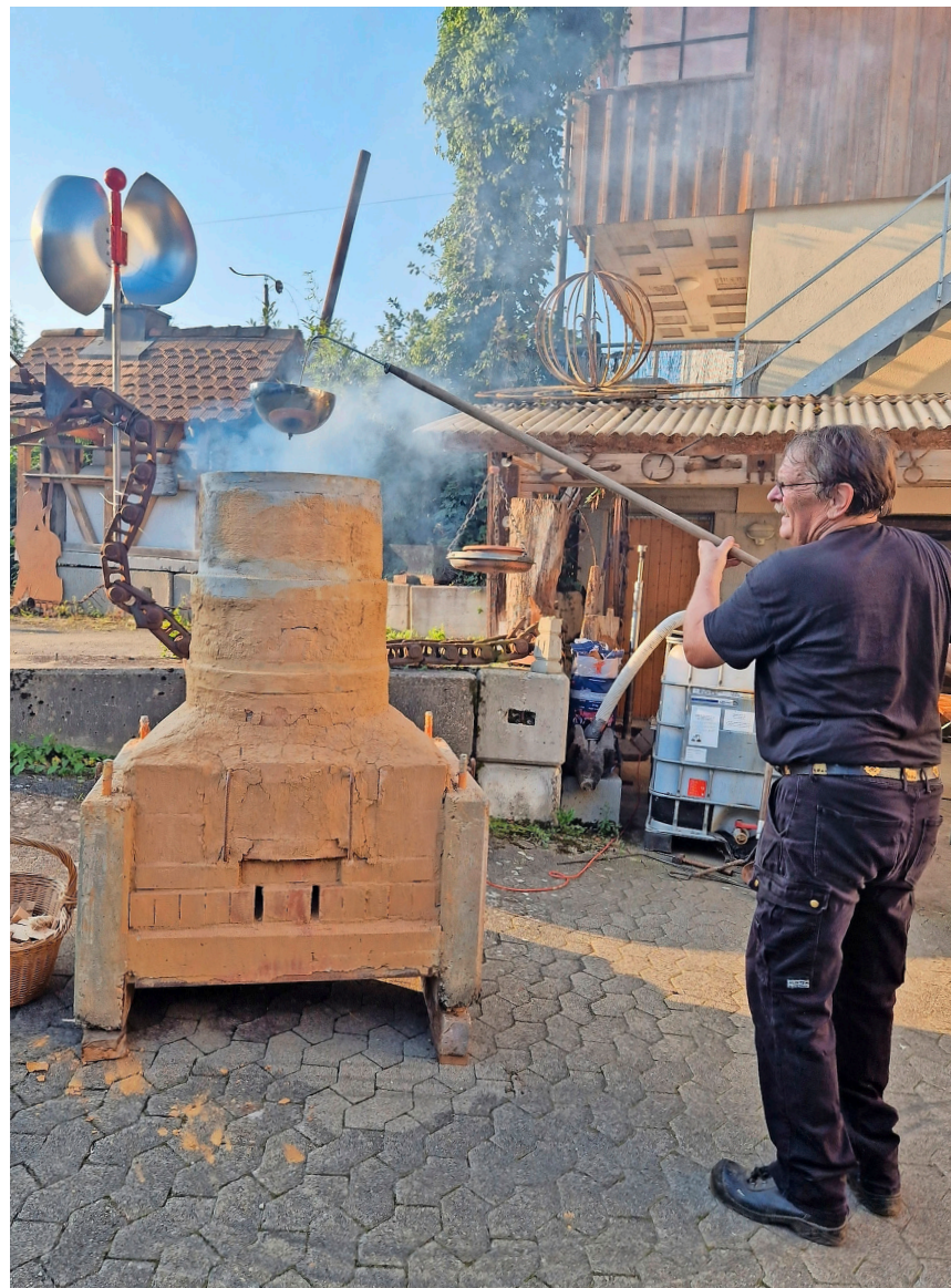
Erich Schwaninger kontrolliert die Hitze im Rennofen mit einem Spiegel. Bilder rechts: Bohnerz aus dem Hemming hat einen Eisengehalt von 35 bis 50 Prozent (oben). Ofen mit Luppe nach dem Öffnen (Eisen und Schlackengemisch).
