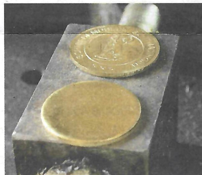
Dieser seltene Fallhammer gehört seit kurzem zur Sammlung von Erich Schwaninger aus Guntmadingen. Die Münzprägung erfolgt durch reine Muskelkraft.
